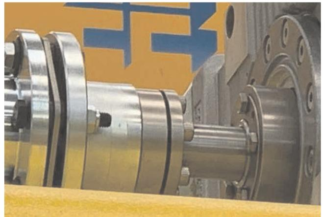
SIT -LOCK ® 3 utilizado para un acoplamiento de disco.
