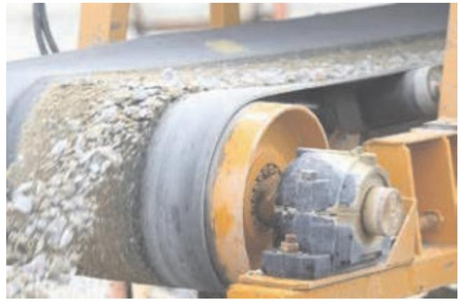
SIT -LOCK ® 1 utilizado para una polea de una banda
