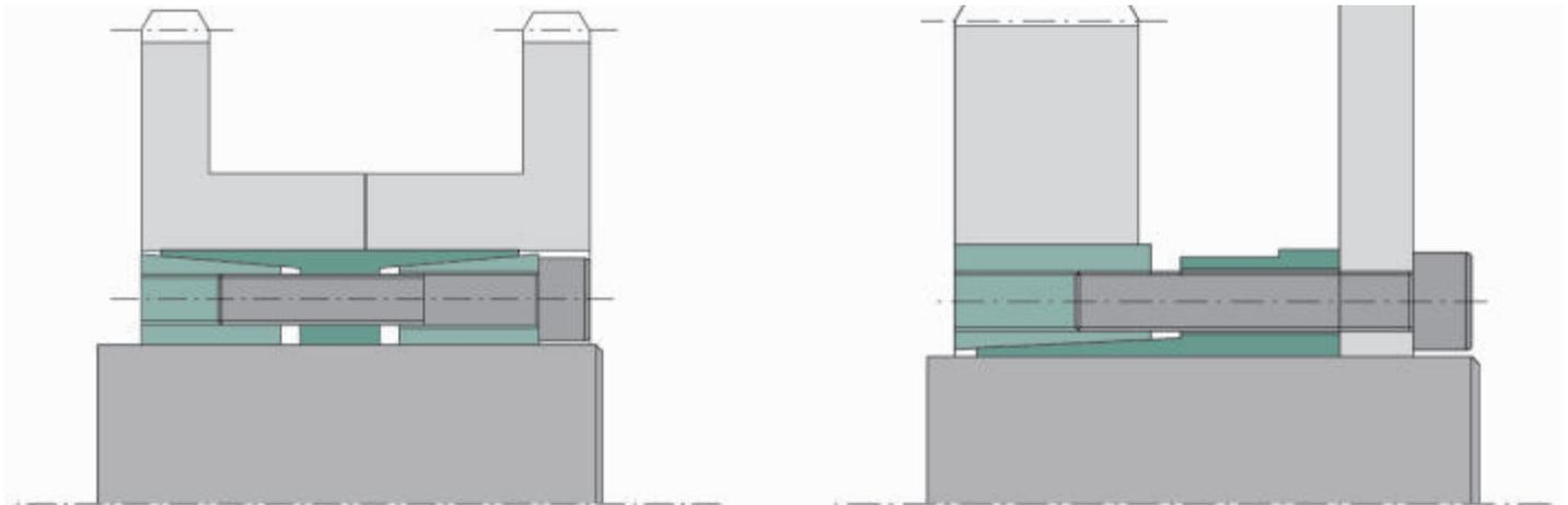
Bloqueo simultáneo de dos piñones mediante SIT-LOCK® 4.
