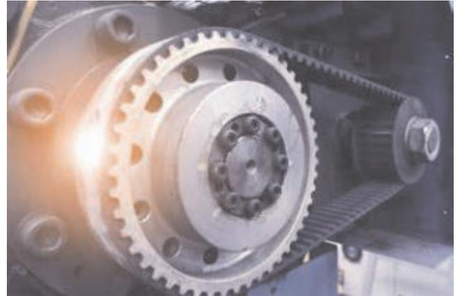
SIT -LOCK ® 5A utilizado para una polea en una correa de transmisión.
