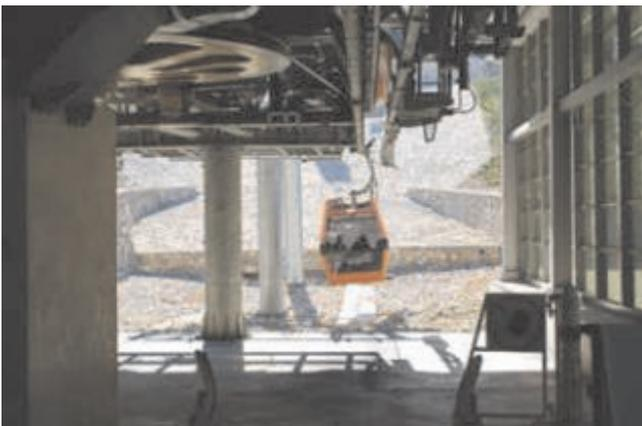
Instalad en una polea en un accionamiento de un teleférico mediante SIT -LOCK ® 4.
