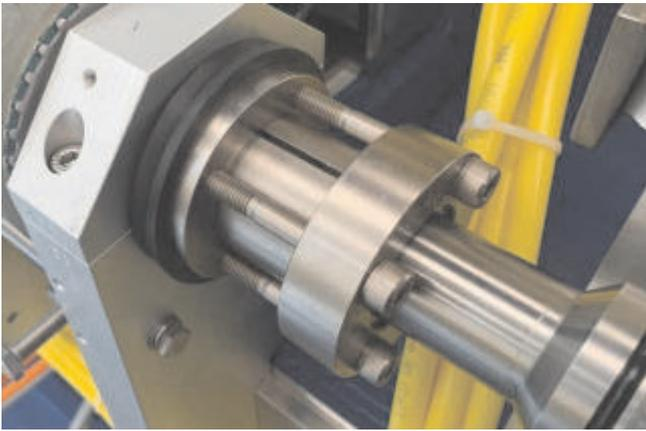
Unión de dos ejes mediante SIT -LOCK ® 10, versión niquelada. transportadora.
